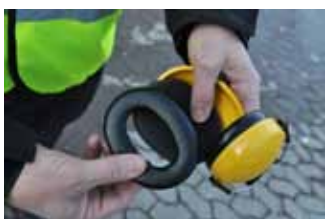
Tætningsringe og indlæg til ørekopper kan rengøres/udskiftes
