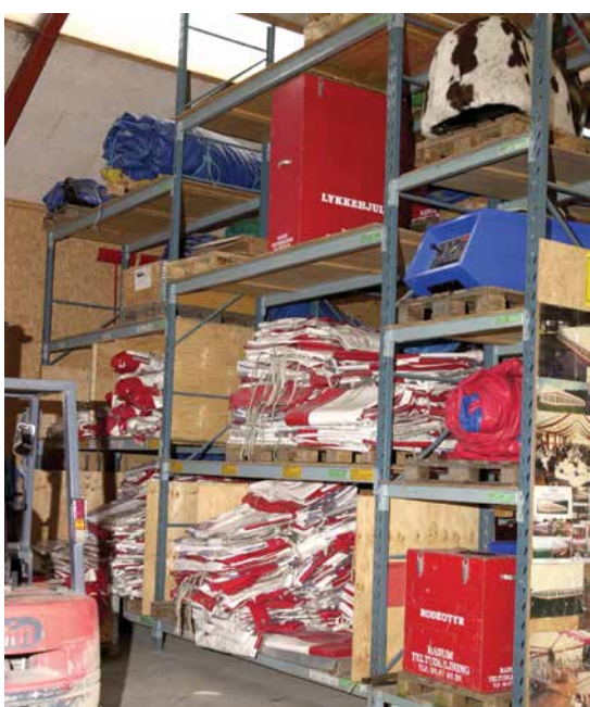
Placer materialet på pallereol-hylderne, så det er let at rutsje delene over på f.eks. en palle, eller ned på en truck, så løft undgås.
