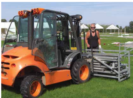
Brug læssemaskine, der f.eks. kan køre ind under tagdugen med gulvplader, borde stole mv., så det kan placeres, hvor det skal bruges.
