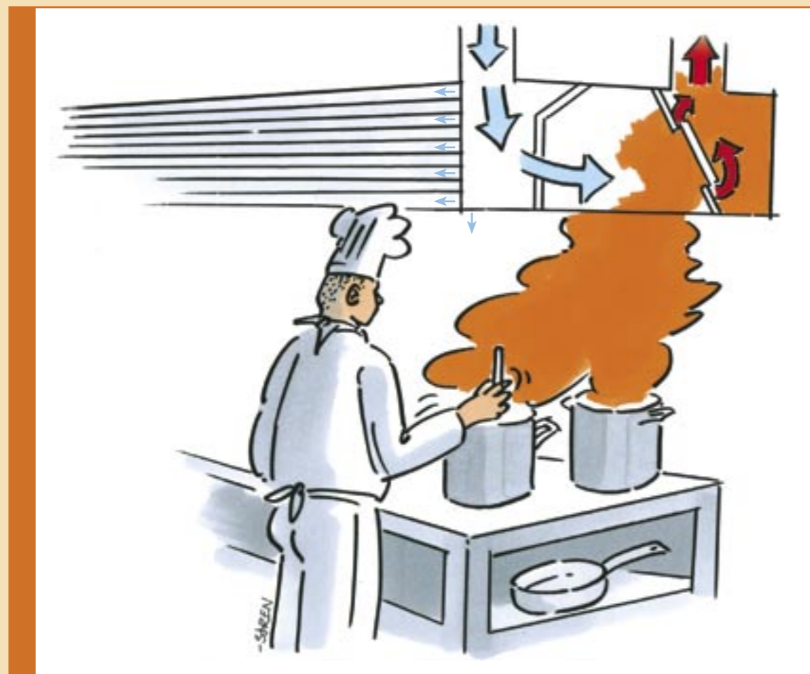
Skitse 2 viser emhætteudsugning med indfangningsstråle Bemærk, at den nedadgående luftstrøm fra emhætten – symboliseret med blå pil – kan reguleres med retningen på luftstrømmen og størrelsen på luftmængden, som der i øvrigt kan lukkes fuldstændigt for.
