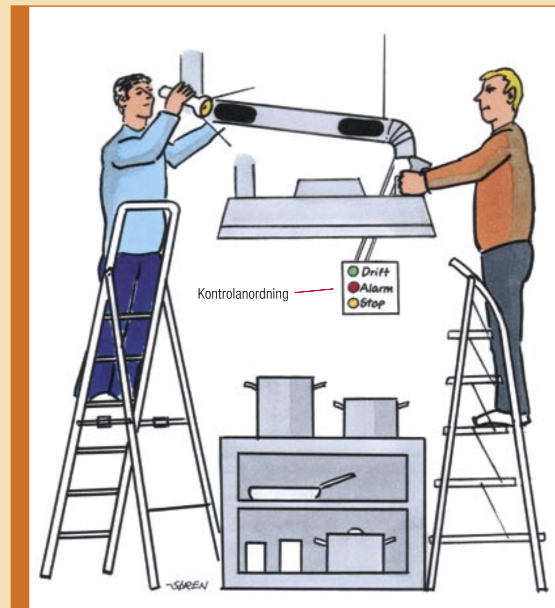
Skitse 12 viser inspektion af udsugningskanal og kontrolanordning
