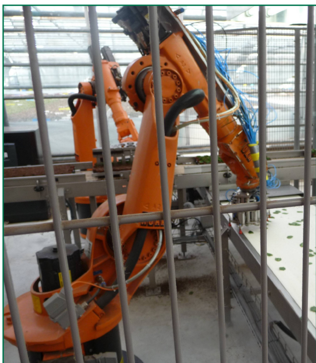
Maksimal sikkerhed omkring robotter til stikling. Maskinerne er helt indkapslede i et "bur" af stål. Adgang til dette er kun muligt, når robotterne er lukket ned.
