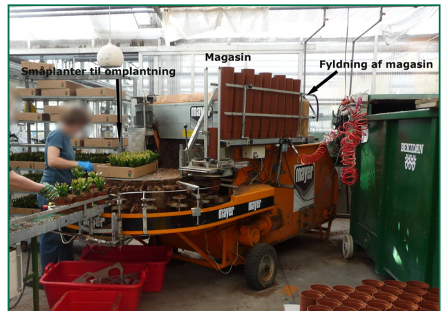
Arbejdsområde ved pottemaskine. Pottemagasinet fyldes i god afstand fra bevægelse dele. Småplanter til omplantning er placeret i bekvem afstand fra arbejdsområdet.
