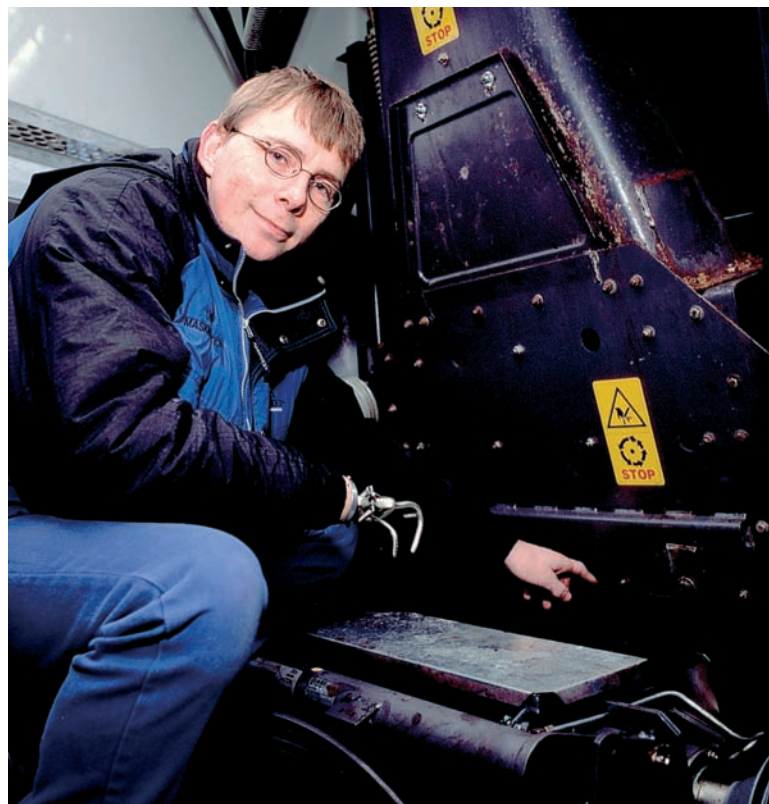
◀ Figur 5.4 Carsten Krarup fra Sdr. Omme i Vestjylland skulle bare lige fjerne en ligegyldig tot græs fra finsnitterens blæser. Uden at tænke på den roterende klippecylinder, der sidder oppe i blæseren, stak Carsten hånden op for at fjerne græstotten. Klippecylinderen fik fat i hans fingre og rev Carstens arm af, fordi klippecylinderen fortsætter med at køre rundt ret lang tid efter, der er slukket for motoren.
