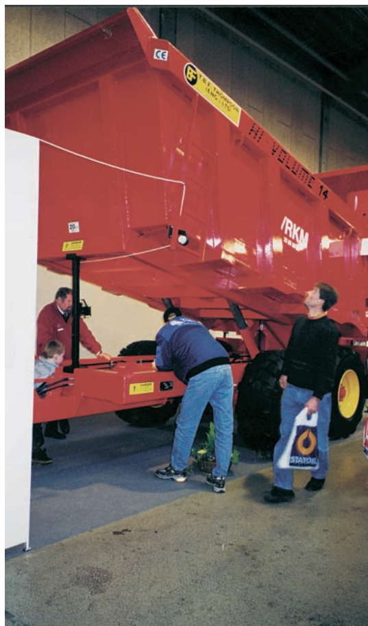
▲ Figur 5.9 Tipvogn med sikkerhedsstang. Stangen forhindrer, at ladet pludselig synker ned under reparation eller eftersyn.
