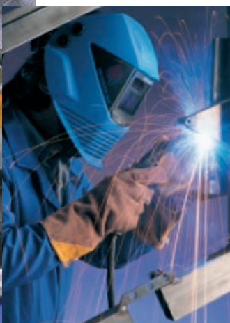
▲ Figur 4.24 Svejsehandske i helfoeret oksespalt med manchete, yder optimal beskyttelse ved svejsning.
