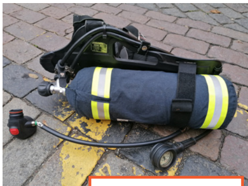
Røgdykker apparat alene vægt 9,5kg
