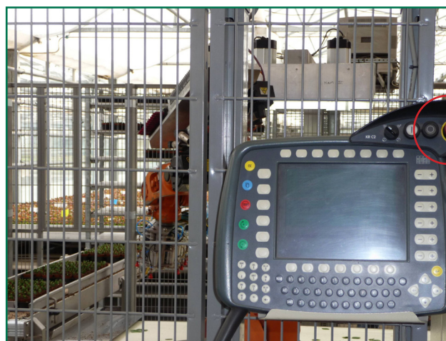
Kontrolpanel anbragt udenfor afskærmning. Bemærk den store knap til nødstop øverst til højre.
